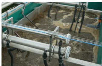
Afb. 5.5 – Zuur afvalwater wordt behandeld met calciumhydroxide (gebluste kalk).
