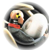
Afb. 3.1 – Bij een botsing wordt de airbag van een auto door een explosieve reactie gevuld met stikstofgas.
